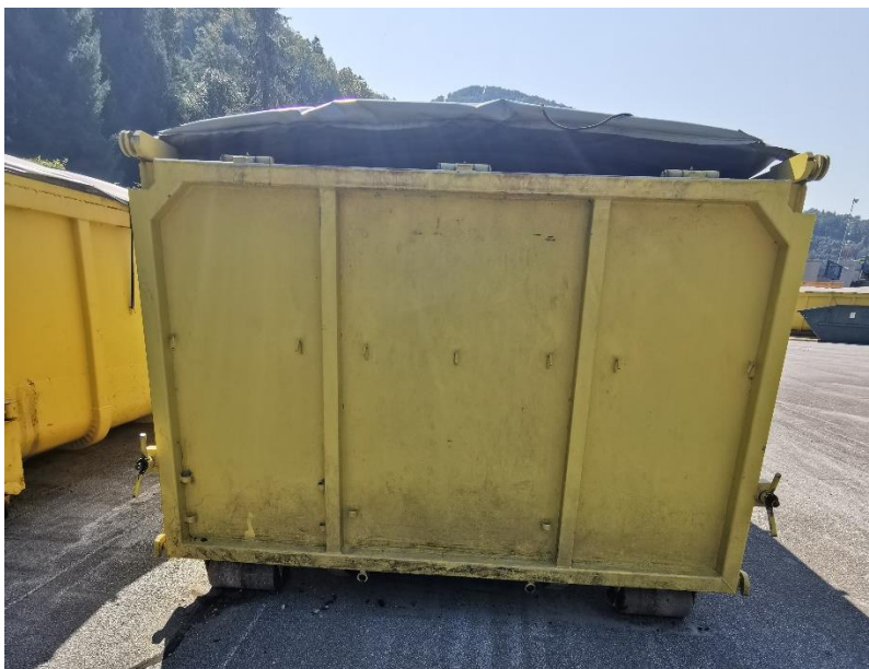
Slika 3: zadnja enokrila vrata na kip sistem z dvojnimi zapiralnimi sistemom
