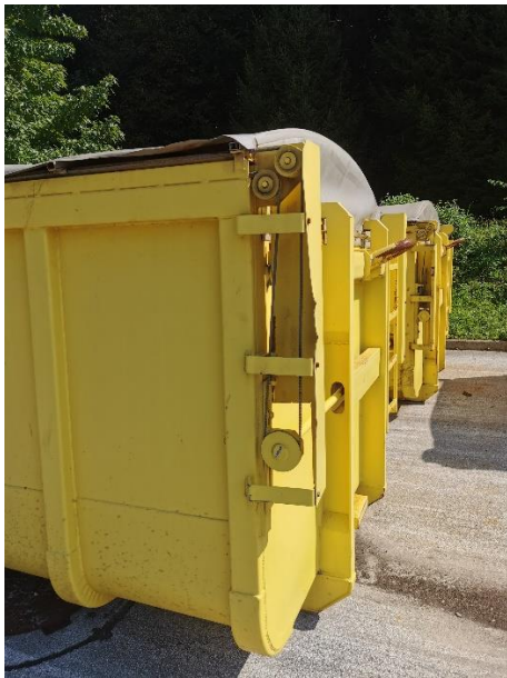
Slika 4: Cerada na način zapiranje/odpiranje s pomočjo jeklenih vrvic
